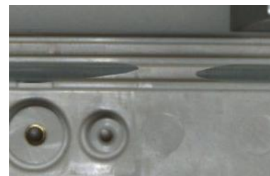
(シーラーの途切れ部分)
